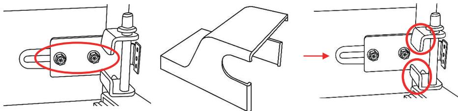
3. В комплект поставки входят еще 2 крышки для петель, они предназначены для нижней и верхней петель. При необходимости их можно закрепить.
