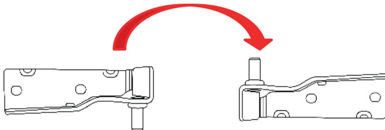
6. Переверните среднюю петлю (на 180°) и вставьте штифт в среднюю петлю (убедившись, что фиксирующая шайба находится сверху), а нижнюю часть штифта вставьте в верхнюю часть дверцы морозильной камеры. Наденьте крепежный разъем на петлю и прикрутите среднюю петлю и крепежный разъем к противоположной стороне холодильника. Перед окончательным затягиванием необходимо убедиться, что дверца морозильной камеры выровнена по горизонтали и вертикали, чтобы дверь закрывалась плотно со всех сторон.
