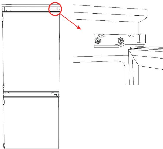
2. Снимите штифт петли и отвинтите 2 винта от средней петли. Снимите петлю и дверцу морозильной камеры, осторожно приподняв ее вверх и убрав от прибора.
