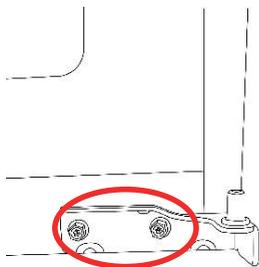
4. Снимите все заглушки винтов с противоположной стороны прибора, там, где будут устанавливаться петли. Закрепите снятые заглушки на противоположной стороне (где снимались петли). При необходимости в комплект поставки входят запасные заглушки.
