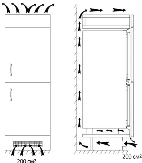
3. Поставьте устройство перед кухонным шкафом и вставьте вилку в розетку. Установите устройство в кухонный шкаф. Аккуратно втолкните внутрь кухонного шкафа.
