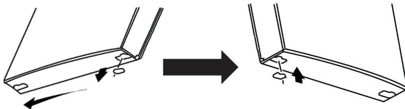
5. Переверните верхнюю петлю на 180° (так, чтобы штифт был направлен вверх) и закрепите на противоположной стороне в нижней части прибора. Установите дверцу морозильной камеры на нижнюю петлю.
