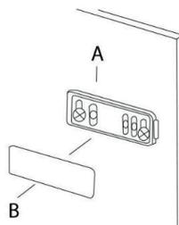
4. Откройте дверь холодильника и дверцу шкафа на 90°, выверните 2 винта из держателя направляющей дверцы, который уже предварительно прикреплен к дверце, и установите его на направляющую (А). Сдвиньте дверцу прибора и дверцу шкафа вместе, совместите отверстия на направляющем держателе дверцы и отверстия по краю дверцы и закрепите на месте с помощью 2 винтов, которые были предварительно вывернуты.
