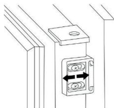
5. Для регулировки, используйте зазоры в пазах держателя направляющей двери.
