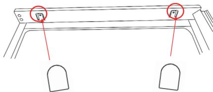
Установите заглушки в нижней части прибора. Пластиковые хвостики на заглушках служат ориентиром, каким должно быть расстояние между прибором и краем шкафа (приблизительно 42 мм). После установки отсоедините пластиковые хвостики.
