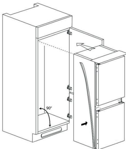
4. Откройте дверцу и прижмите боковую часть прибора без петель к боковой стенке шкафа. Закрепите прибор в двух местах: 2 винтами с головками torx в верхней части прибора и 2 винтами torx в нижней части (по 1 шт.)
